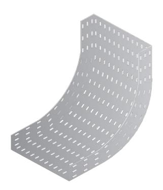
ES UNA CURVA QUE ASCIENDE O DESCIENDE CON UN ÁNGULO DE 90° EN FORMA VERTICAL, LA CUAL PERMITE REALIZAR CAMBIOS DE DIRECCIÓN A UN PLANO DIFERENTE. LA CURVA VERTICAL INTERNA REALIZA CAMBIOS DE DIRECCIÓN DEL PLANO HORIZONTAL AL VERTICAL O VICEVERSA EN FORMA ASCENDENTE, MIENTRAS QUE LA CURVA VERTICAL EXTERNA REALIZA DICHOS CAMBIOS EN FORMA DESCENDENTE.
