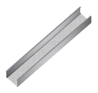
LA BANDEJA CON FONDO DE MALLA CONSISTE DE DOS RIELES LATERALES ELABORADOS DE ACERO, ENTRE LOS CUALES SE COLOCA UNA MALLA (MATERIAL Y MEDIDA), EL ENSAMBLAJE DE ESTA BANDEJA DESPUÉS DE SU FABRICACIÓN ES GALVANIZADA EN CALIENTE POR INMERSIÓN EN CINC FUNDIDO. CON ESTE TIPO DE BANDEJA SE PERMITE QUE EL CABLEADO TENGA MAYOR VENTILACIÓN Y NO PERMITE QUE LOS CABLES ESTÉN SUSPENDIDOS EN EL AIRE.
