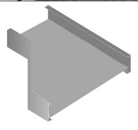
UNA REDUCCIÓN A MANO DERECHA ES AQUELLA EN LA CUAL LA SECCIÓN LARGA SE VE DEL LADO DERECHO, LOS SOPORTES DEBEN SER COLOCADOS DENTRO DE LOS 60 CM DE SECCIÓN RECTA EN CADA EXTREMO.
