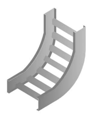
ES UNA CURVA QUE ASCIENDE O DESCIENDE CON UN ÁNGULO DE 90° EN FORMA VERTICAL, LA CUAL PERMITE REALIZAR CAMBIOS DE DIRECCIÓN A UN PLANO DIFERENTE. LA CURVA VERTICAL INTERNA REALIZA CAMBIOS DE DIRECCIÓN DEL PLANO HORIZONTAL AL VERTICAL O VICEVERSA EN FORMA ASCENDENTE, MIENTRAS QUE LA CURVA VERTICAL EXTERNA REALIZA DICHOS CAMBIOS EN FORMA DESCENDENTE.
