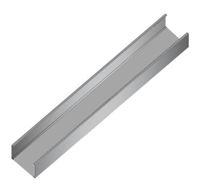
CANAL LISO CONSISTE EN UNA LAMINA DE ACERO, A LA QUE SE LE APLICA UN DOBLEZ EN SUS LADOS, PARA GENERAR LA FORMA DE LOS RIELES LATERALES, ESTA PIEZA DESPUÉS DE SU FABRICACIÓN ES GALVANIZADA EN CALIENTE POR INMERSIÓN EN CINC FUNDIDO. ESTE TIPO DE BANDEJA, LE OFRECE AL CABLEADO LA MAS ALTA PROTECCIÓN Y EVITANDO QUE ESTOS QUEDEN SUSPENDIDOS EN EL AIRE
