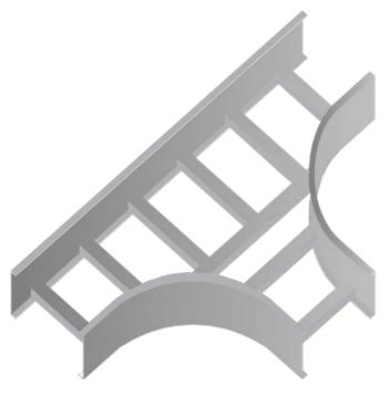
SON ELABORADAS CON LAMINAS DE ACERO DE 1.5 MM, 2 MM Y 2.5 MM DE ESPESOR, SUS LATERALES SON PROCESADOS POR MAQUINARIA ESPECIAL QUE DAN LA FORMA AL SEGMENTO DE ARCO CON EL ÁNGULO PRECISO MANTENIENDO SIN DEFORMACIÓN LAS CARACTERÍSTICAS MECÁNICAS DE LOS RIELES LATERALES. ESTA PIEZA POSEE UNA CURVA QUE PERMITE REALIZAR INTERCEPCIONES DE BANDEJAS PORTACABLES CON UN ÁNGULO DE 90° EN EL MISMO PLANO HORIZONTAL.
