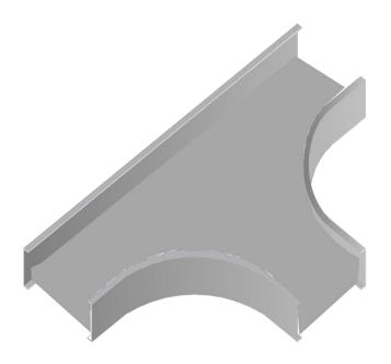
SON ELABORADAS CON LAMINAS DE ACERO DE 1.5 MM, 2 MM Y 2.5 MM DE ESPESOR, SUS LATERALES SON PROCESADOS POR MAQUINARIA ESPECIAL QUE DAN LA FORMA AL SEGMENTO DE ARCO CON EL ÁNGULO PRECISO MANTENIENDO SIN DEFORMACIÓN LAS CARACTERÍSTICAS MECÁNICAS DE LOS RIELES LATERALES. ESTA PIEZA POSEE UNA CURVA QUE PERMITE REALIZAR INTERCEPCIONES DE BANDEJAS PORTACABLES CON UN ÁNGULO DE 90° EN EL MISMO PLANO HORIZONTAL.
