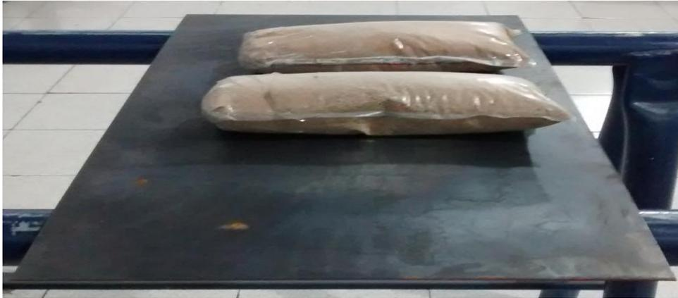
**Sacos de arena de 2kg y lámina de hierro negro de 3mm de espesor usados como material cargante**
